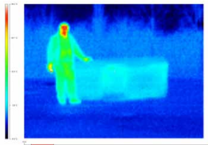
A Wellis medence hőterképes vizsgálata során kiváló eredményeket ért el, a képen látható medencében lévő víz hőmérséklete 35 °C a külső borítás és a thermotető csupán 4 °C. A külső hőmérséklet -5 °C.
