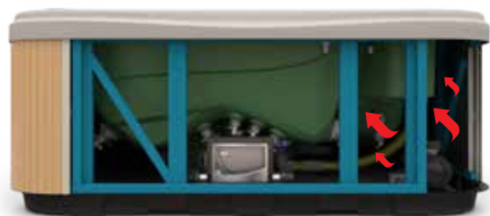
A Wellis medence tripla szigetelésének köszönhetően a gépészetből felszabaduló hőt a hőtükrös fólia visszaveri a medenceházon belül, miközben fűti a medencehéjat és a vizet.
