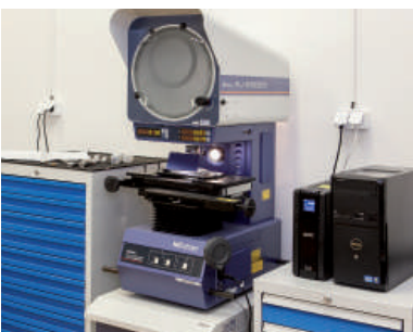
Profil projektor. Minőség-ellenőrzési laboratórium.
