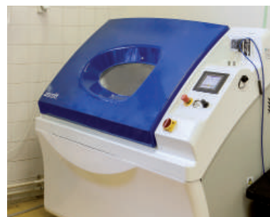
Korróziós kamra az extrém körülményszimulálásához az anyagvizsgálatok számára.
